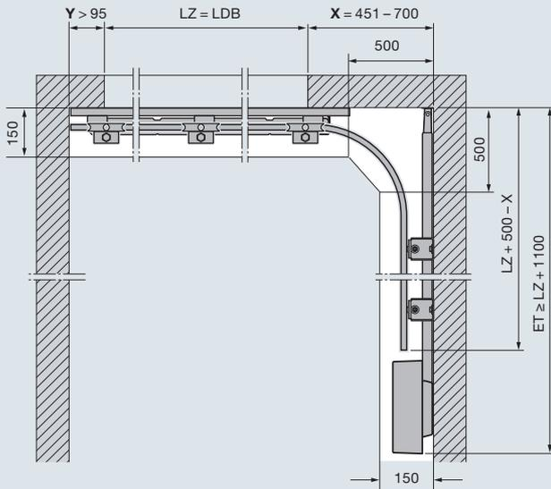
**ES-Beschlag** (Einfachschiene) Antrieb Deckenmontage A
