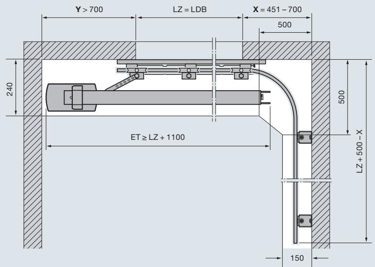
**DS-Beschlag** (Doppelschiene) Antrieb Wandmontage
