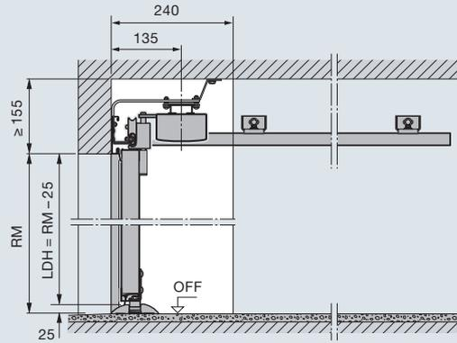
**ES-Beschlag** (Einfachschiene) Antrieb Wandmontage
