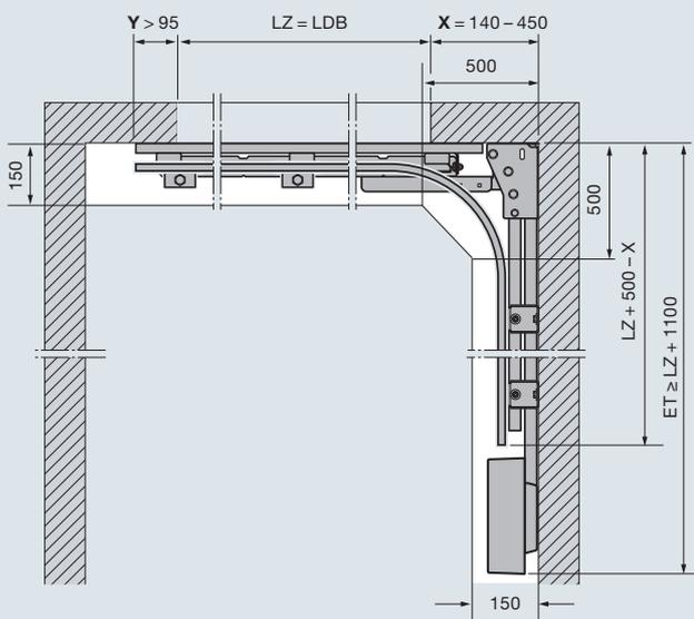
**ES-Beschlag** (Einfachschiene) Antrieb Deckenmontage B
