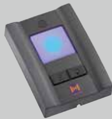
Indvendig trykkontakt PB 3 Belyst impuls-knap til åbning og lukning af porten, knap til portåbnerlys og knap til frakobling af det trådløse system (til SupraMatic)
